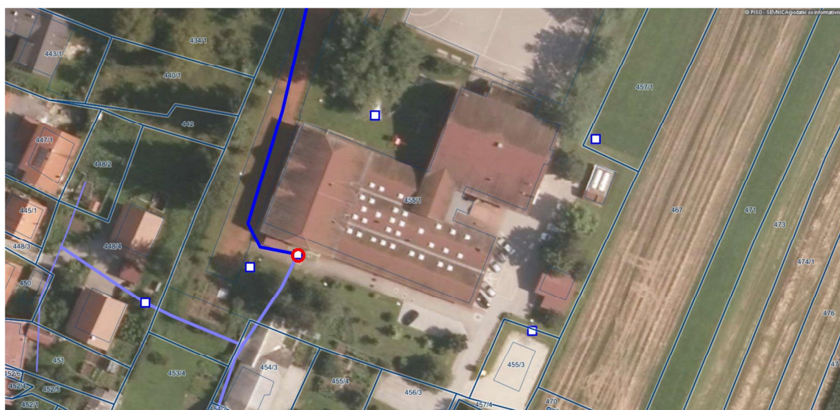
Slika 3: prikaz poteka vodovoda iz javnih evidenc (modra – vodovod)
